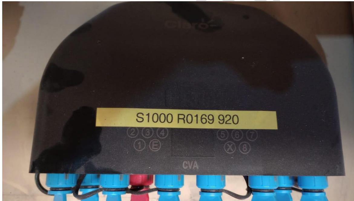
Las **CVA** es la anteúltima caja que podemos encontrar cuando realizamos el despliegue hacia un edificio. Esta misma tiene la capacidad de alimentar a 8 **CVB**, otra de las funciones que le damos a esta caja es la de “ampliación”, la ampliación sirve para cuando tenemos
